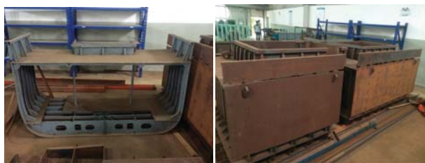
图5 1:10 钢制 57000t 散货船双层底分段
