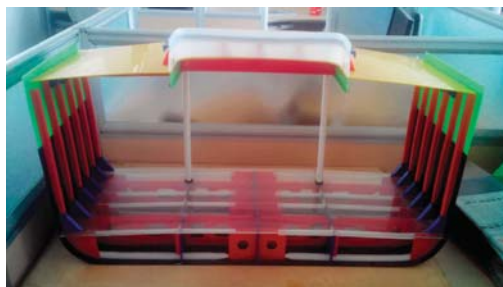
图4 1:100 有机玻璃双层底分段缩比模型
