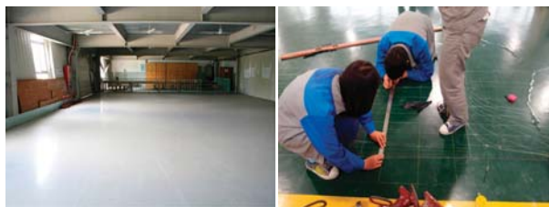
图2 学生进行船体放样操作
