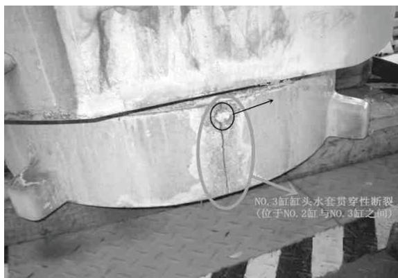
图 1 NO.3 缸缸头水套纵向断裂
