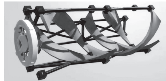
图 4 螺旋滑套结构三维示意图
