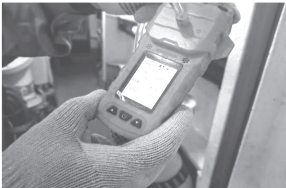
图2 使用气体检测仪对舱室环境进行检测
