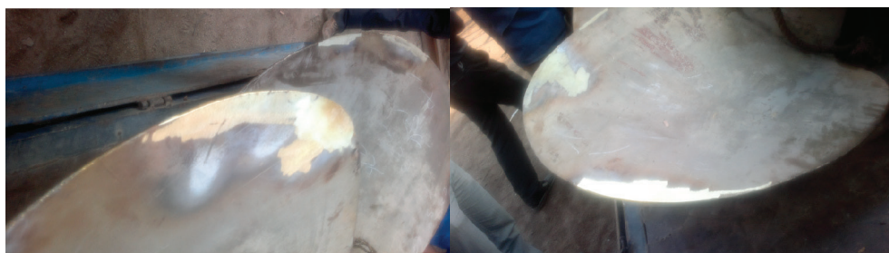
图6 修复后的桨叶
